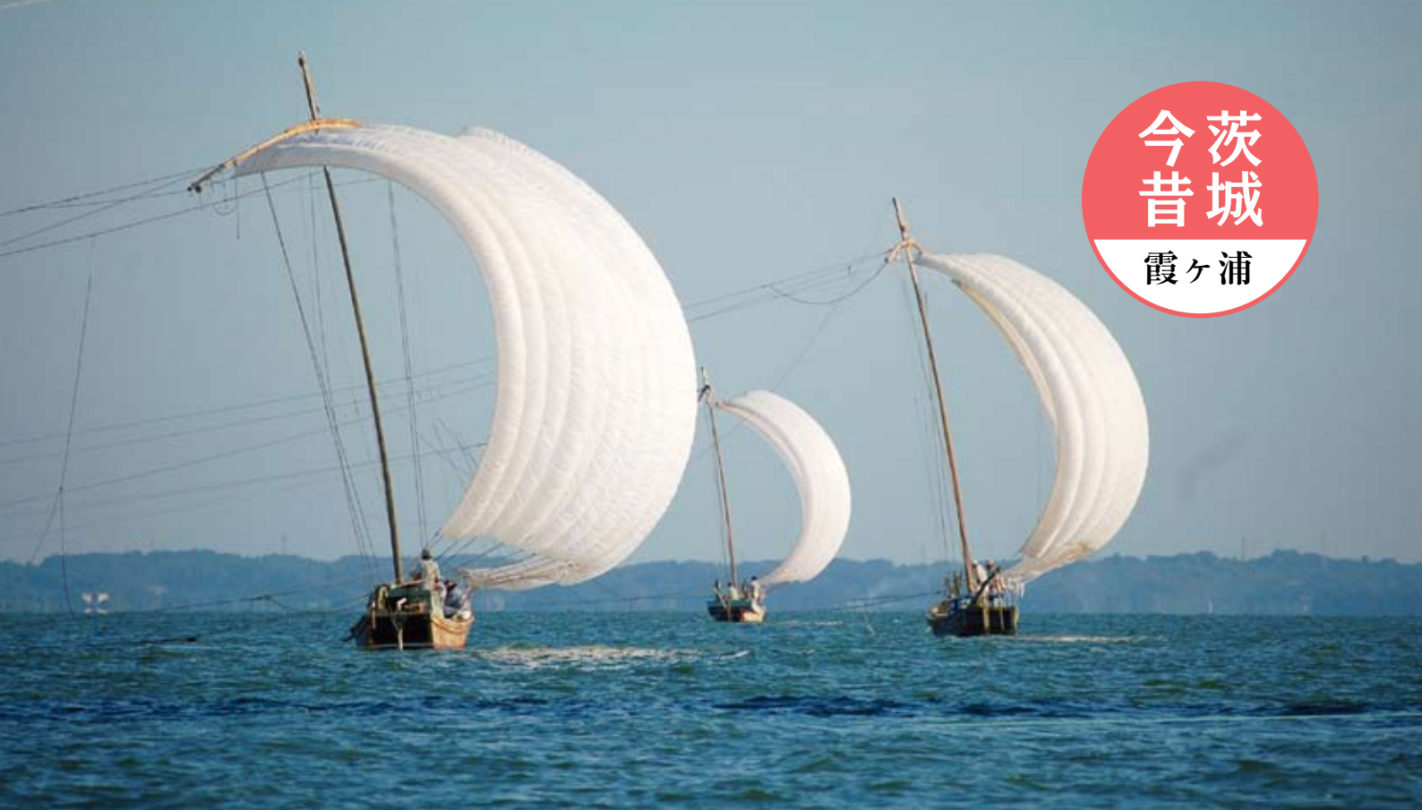
風の原理を応用した帆引き船は、風の力によって船を横に流して漁を行う。現在は観光用に操業している。(写真提供：かすみがうら市役所)
